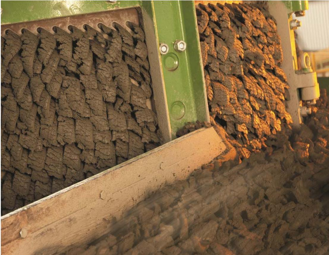
L'argilla è prelevata dai silos di stoccaggio mediante un escavatore a tazze su rotaia e dosata mediante un cassone dosatore.
