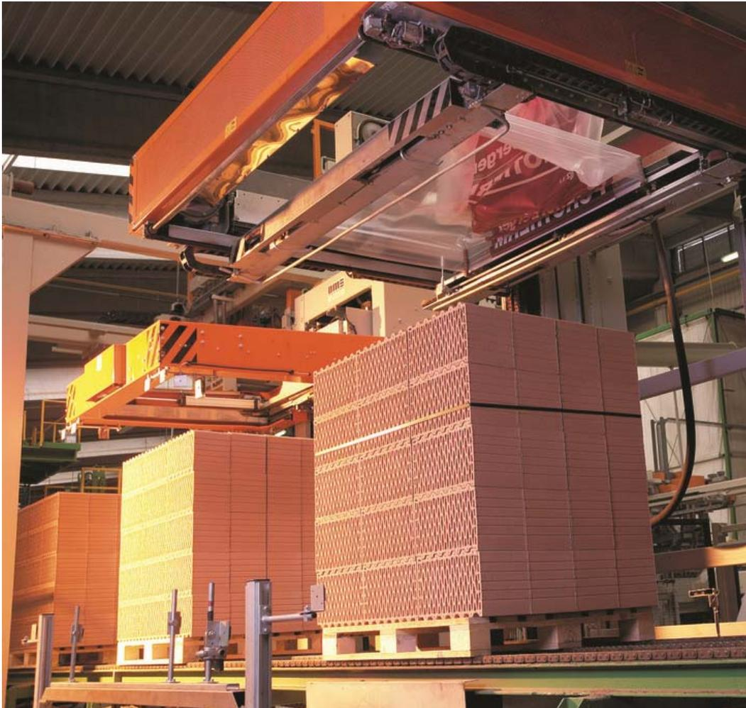
I carri con il prodotto finito in uscita dal forno sono movimentati con un sistema automatico verso la linea di scarico e imballaggio.
