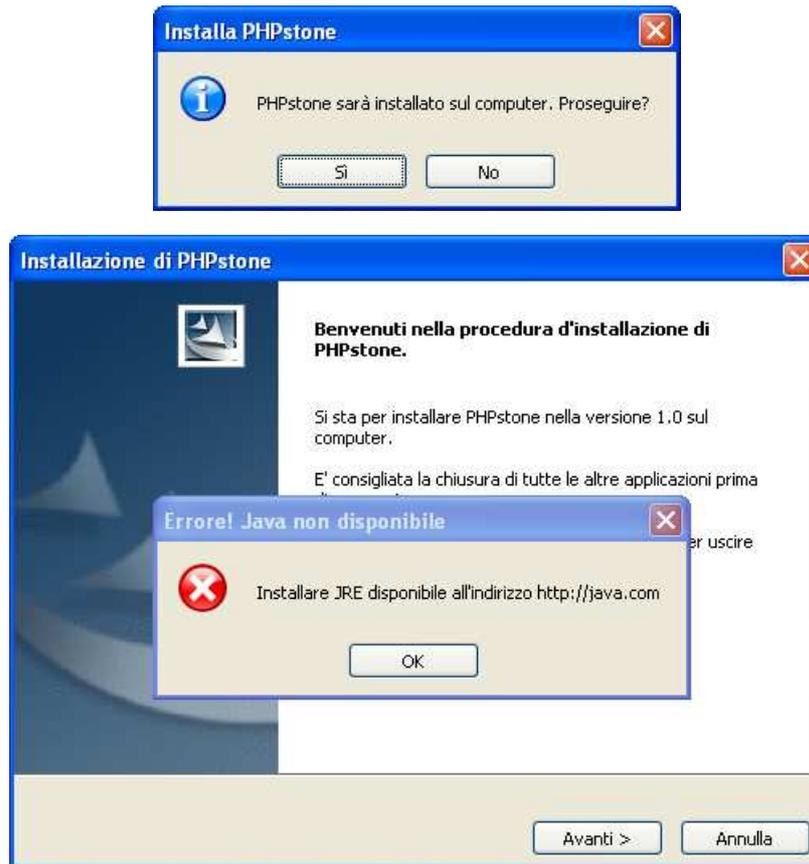
Figura 2 – Installazione del software *PHPstone*, in assenza del software *JRE6-23* sul PC.
