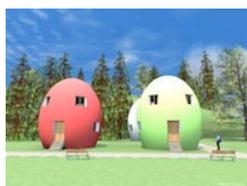
**Doppia membrana** : L'edificio, che concilia l'aspetto curvilineo con le esigenze degli inquilini, è rivestito da due membrane (una interna con forma poliedrica regolare e una esterna a forma di uovo) che funzionano sia come parete ventilata oppure come sistema integrato di recupero dell'energia eolica e solare in copertura.
